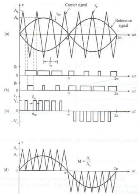
**Figure 5: Sinusoidal PWM**
